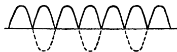
Рис. 85. Сплошной линией показана форма тока при двухполупериодном выпрямлении; пунктиром изображены полупериоды, задержанные одним выпрямителем, но выпрямленные другим.
