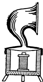
Рис. 98. Устройство электромагнитного громкоговорителя с рупором.
