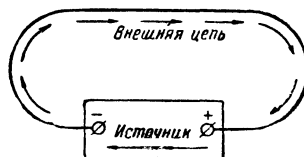
Рис. 132. Движение электронов через источник питания и по внешней цепи.
