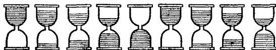
Рис. 29. В песочных часах уровень песка постепенно поднимается вплоть до момента, когда их переворачивают, после чего все начинается сначала. То же происходит и с напряжением на зажимах конденсатора во временной развертке.
