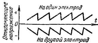
Рис. 55. Форма напряжений на отклоняющих электродах при двухтактном питании.
