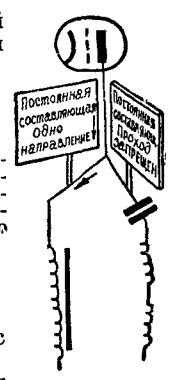
Рис. 58. Схема усилителя с индуктивной нагрузкой для питания катушек магнитного отклонения L . Используется преимущественно для вертикального отклонения.
