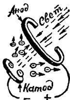
Рис. 64. Схема, иллюстрирующая метод передачи изменения яркости одного из элементов изображения.
