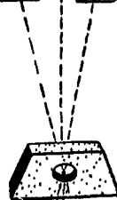
Рис. 137. Пути электронных лучей через отверстия маски к экрану трехцветного кинескопа.
